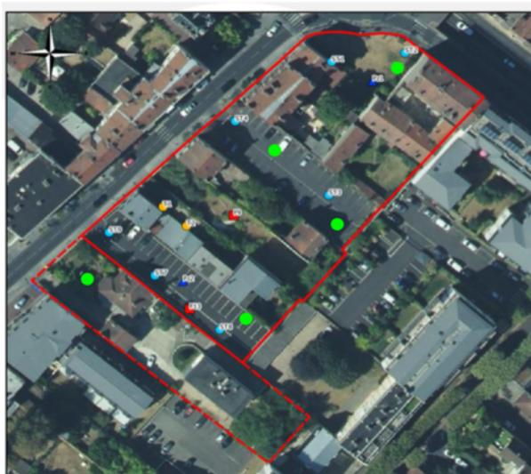
Les sondages ont montré la présence d'un horizon de remblais à des profondeurs variables (0,5 à 1,5 m).
