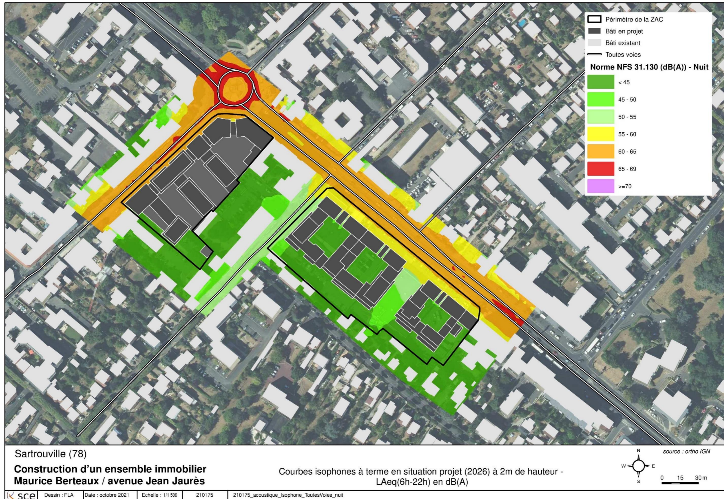
Figure 150 - Cartographie par courbes isophones à l'état de projet (horizon 2026) en période nocturne
